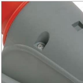
В стационарных разъемах боковые отверстия под винты для сборки двух половин корпуса располагаются внутри корпуса и снаружи не видны. После сборки головки винтов оказываются утопленными в нише, что исключает их повреждение.
