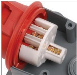
В разъемах серии MAGNUM используются зажимы столбчатого типа с двумя винтами. Винты направлены в одну сторону для удобства монтажа. Зажим прочно закрепляет проводник, обеспечивает низкое переходное сопротивление, меньший нагрев. Торцы винтов зашлифованы, что исключает перерезание жил.
