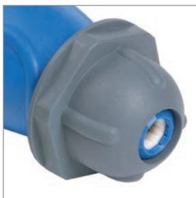
Для затяжки цангового зажима применена гайка, имеющая шлицы для отвинчивания и завинчивания. Борт на шестигранной поверхности сделан для упора, он предотвращает соскакивание ключа. Для удобства закручивания гайки рукой на наружной поверхности сделаны специальные выступы-упоры.
