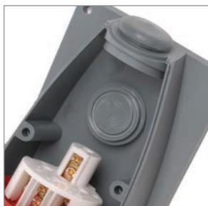
Стационарные разъемы имеют два ввода для кабеля – донный и верхний. В обоих вводах имеются пластиковые мембраны для обеспечения степени защиты IP, срезаемые перед установкой сальника во ввод.
