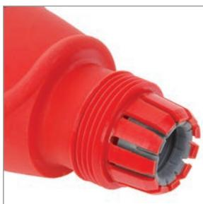
В конструкции переносных разъемов применен цанговый зажим с сальником из эластичного материала. Конструкция цангового зажима, благодаря наличию зубцов на цангах, обеспечивает при затяжке гайки надежную фиксацию кабеля в корпусе, а также требуемую степень защиты IP.
